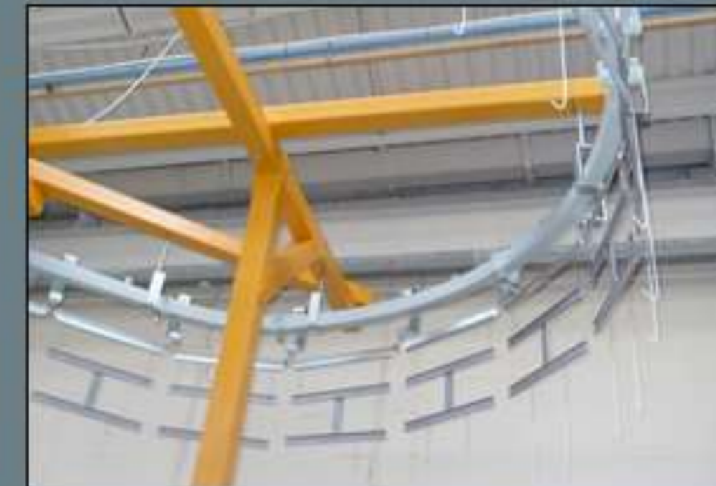
Kreisförderer - C•Haken im Einsatz
