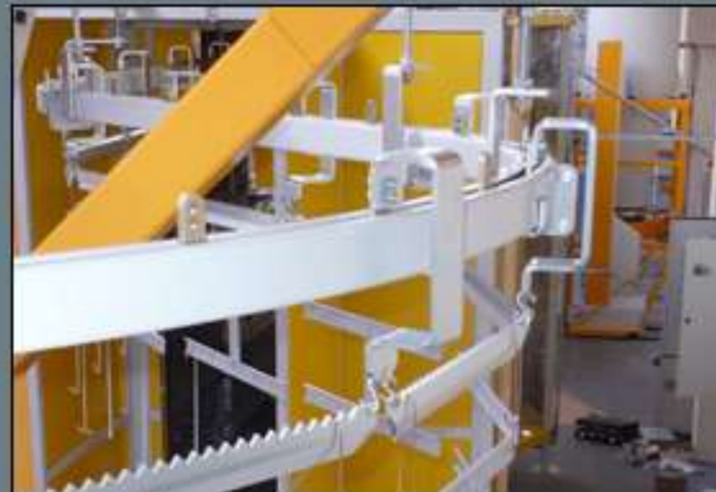
Kreisförderer - C•Haken im Einsatz
