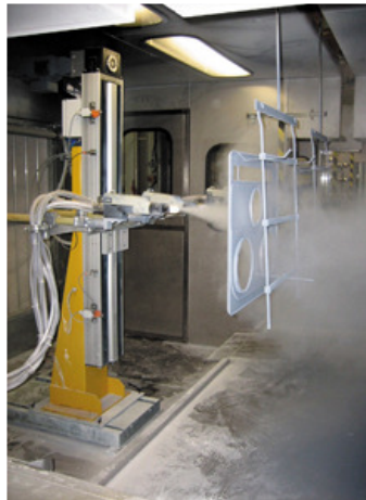
24. kép: Elektrosztatikus zománcpor felvitel [49]
