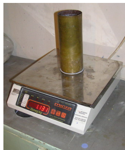
10. kép: A litersúly mérése [39]
