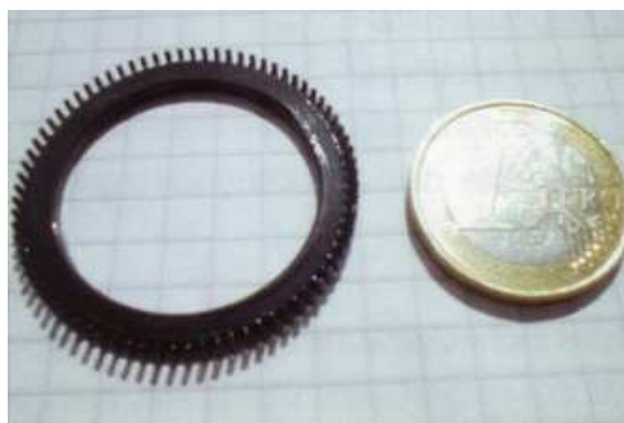
8. ábra Miniatűr zománcozott fogaskerék utólag megmunkált folyamatos anyagból.
