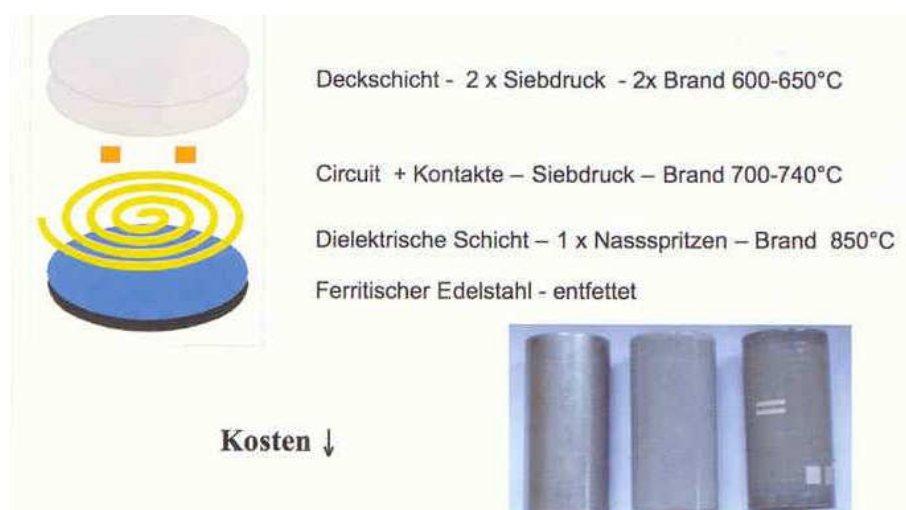
2. ábra Fűtőelemek felépítése nedves szórással + szitanyomás technológia
