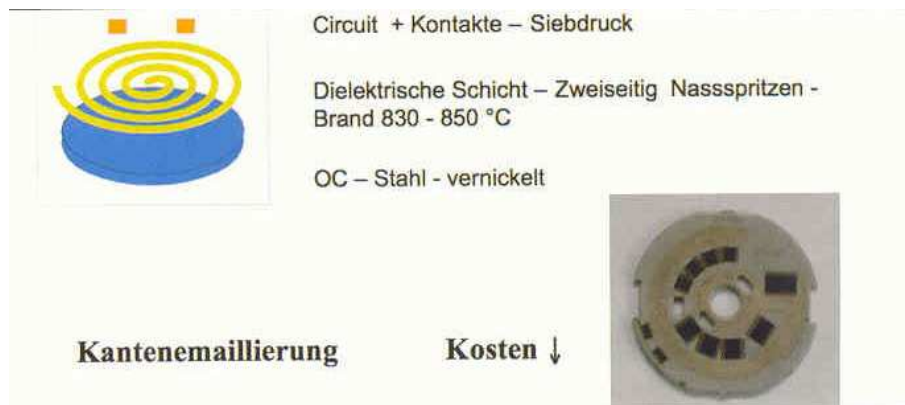
3. ábra Fűtőelem felépítés nedves szórással + szitanyomás technológia
