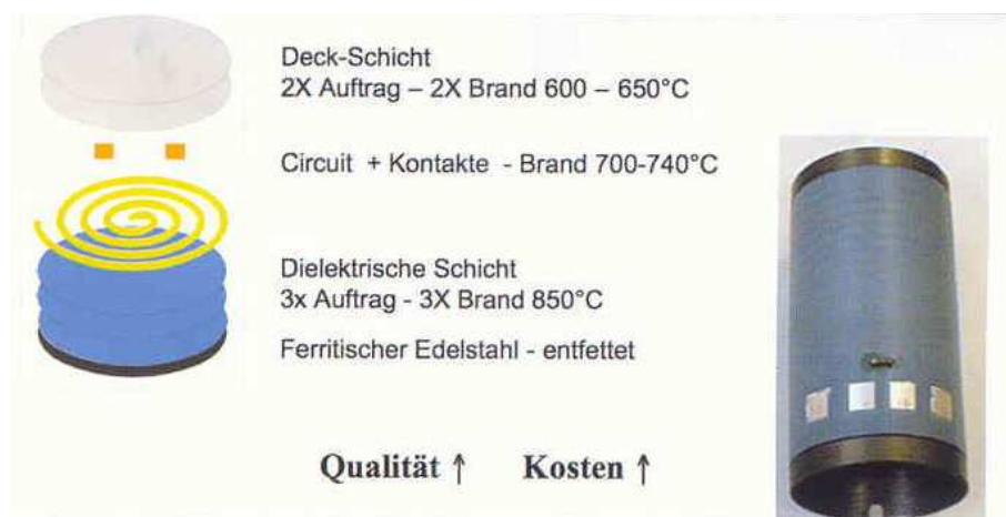
1. ábra Fűtőelemek felépítése szitanyomás technológiával
