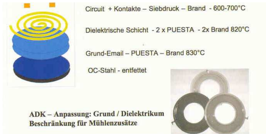
4. ábra Fűtőelem felépítése PUESTA-val + szitanyomás technológia
