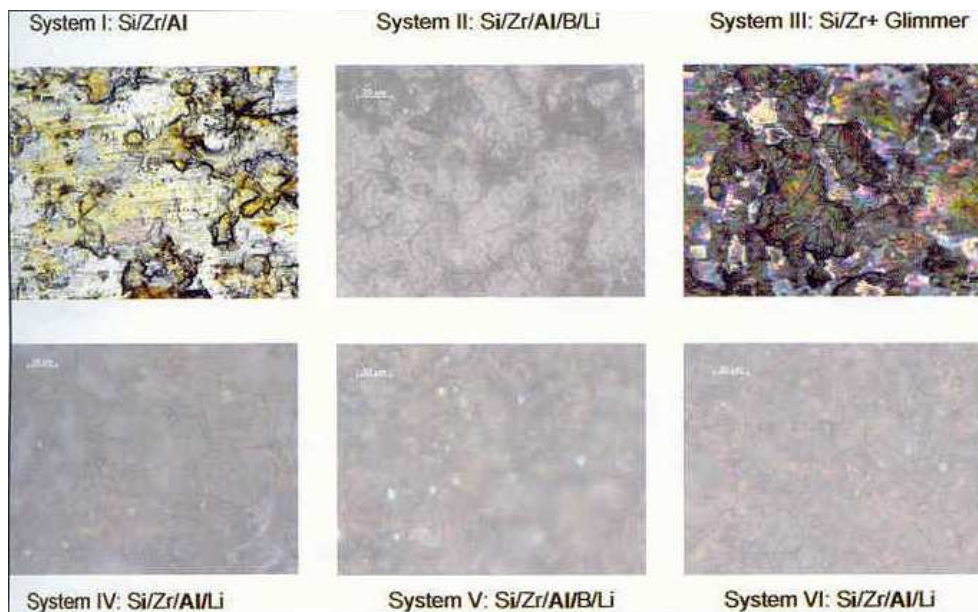
9. ábra: Szól-diszperziós réteg mikroszkópos felvétele St 35.8 fémen, 7 komponenses kötőréteggel.
