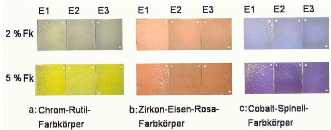
4. ábra A zománc színtónusa és színintenzitása különböző nemesacél fajtákon.
