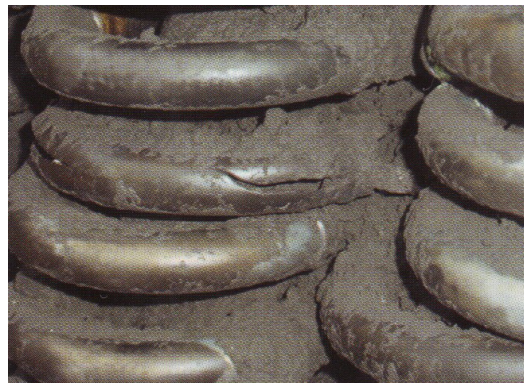
3. ábra Szállóhamu részecskék feltapadása duplex acél csőre.
